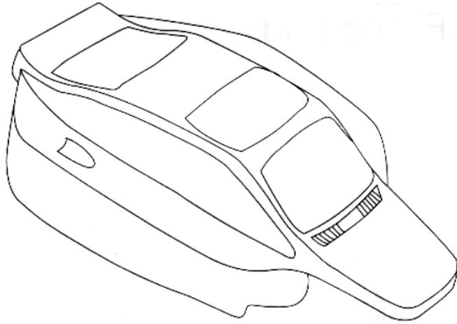
Установите кузов и спойлер на ходовую часть автомобиля.
