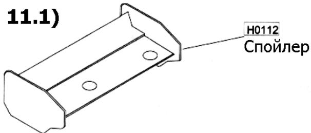
Вырежьте кузов и спойлер и покройте их поликарбонатом из баллончика.
