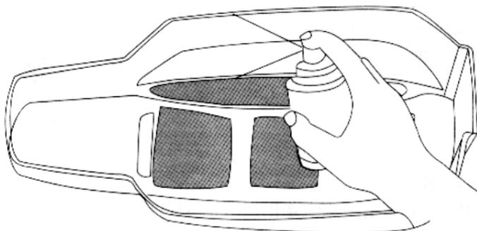
Перед нанесением состава из баллончика промойте внутреннюю часть кузова мягким моющим средством и заклейте окна автомобиля при помощи бумажных стикеров.
