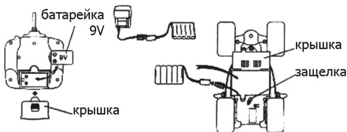
1. Откройте крышку отделения для батарейки в задней части пульта управления. Вставьте батарейку 9V, соблюдая полярность. Закройте крышку.
