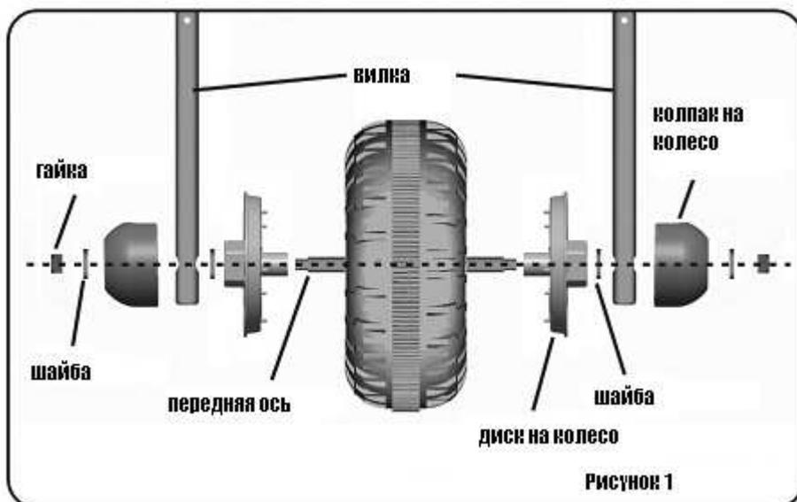
Вставьте диски с обеих сторон переднего колеса. Закрепите другие части в соответствии с рисунком 1, закрутите гайками с обеих сторон.
