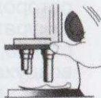
7. Используя регулятор увеличения максимально приблизьте линзу к образцу. Затем, наблюдая в окуляр, поворачивайте регулятор против часовой стрелки до получения ясного изображения.
