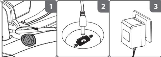
1. Поверните крышку гнезда зарядки против часовой стрелки и снимите крышку.
