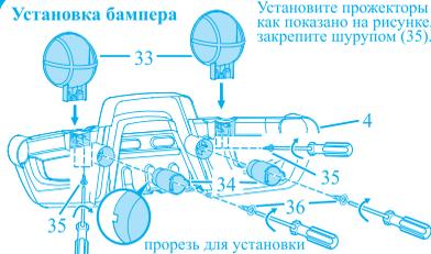
Установите крепление переднего бампера (34), обратите внимание на прорези для установки. Вставьте фиксатор и закрепите шурупом (36).
