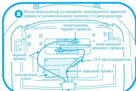
Внимание! Уделите внимание подключению проводов. При неправильном подключении (подсоединение проводов разных цветов) может произойти короткое замыкание и возгорание.
