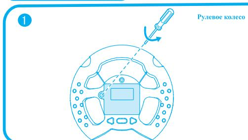
Откройте отсек для батареек в рулевом колесе, вставьте 3 батарейки АА, соблюдая полярность. Закройте отделение крышкой и закрутите отверткой.
