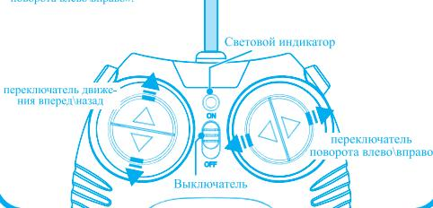
Пульт управления работает на расстоянии до 30м. Если зона приема сигнала уменьшилась, замените батарейки.
