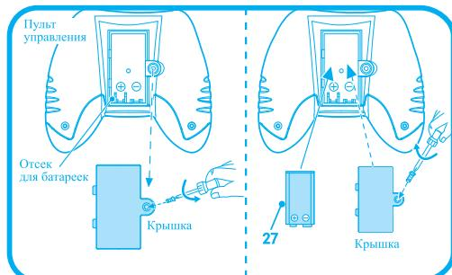
С помощью отвертки откройте отсек для батареек, вставьте батарейку, соблюдая полярность, закройте отделение крышкой и закрутите отверткой.
