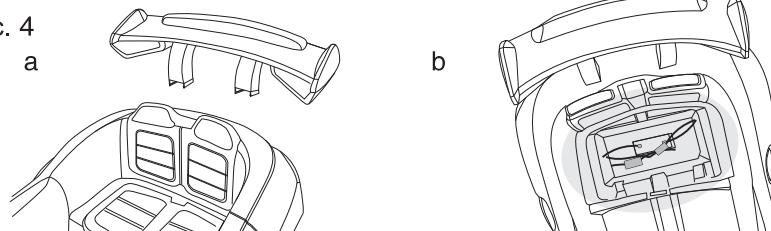
Как показано на рис.4, подсоедините провод спойлера к проводу автомобиля, установите спойлер в соответствующие отверстия в задней части автомобиля. Подсоедините желтый\синий провод мотора к аккумулятору (желтый к желтому,
