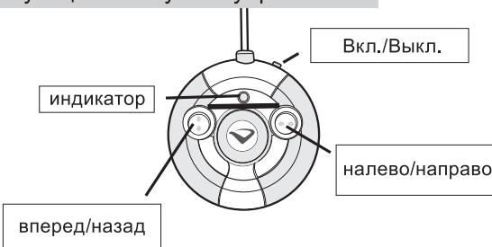
При включении пульта управления загорается световой индикатор. Машина будет двигаться вперед/назад при использовании рычагов «вперед\назад» на пульте управления. Если отпустить рычаг, машина остановится. Автомобиль поворачивает, если вы поворачиваете соответствующий рычаг.
