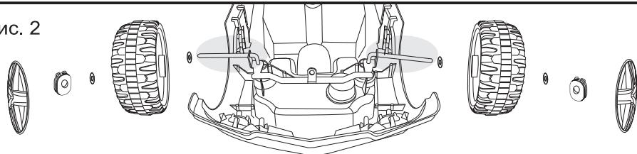
Снимите защитные кожухи с передней оси, смажьте ось маслом. Как показано на рисунке, наденьте уплотнительное кольцо, колесо, уплотнительное кольцо, шайбу. Повторите те же действия для установки второго колеса.
