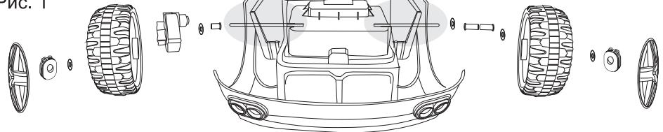
Снимите защитные кожухи с задней оси, смажьте ось маслом. Как показано на рисунке, наденьте с левой стороны 14мм втулку и уплотнительное кольцо, редуктор, колесо, уплотнительное кольцо, шайбу. На правую сторону наденьте уплотнительное кольцо, втулку 14мм, втулку 35мм, уплотнительное кольцо, колесо, уплотнительное кольцо, шайбу и колпак для колеса с обеих сторон.
