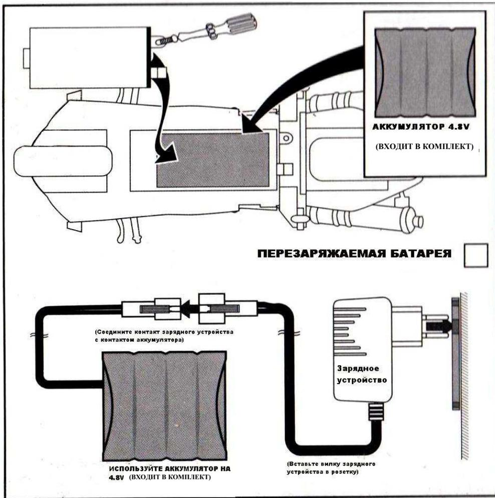
По окончании процесса подзарядки отсоедините аккумулятор от зарядного устройства и выньте зарядное устройство из сети. В процессе подзарядки аккумулятор и зарядное устройство могут немного нагреваться.
