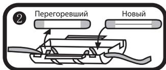
2. Для замены сгоревшего предохранителя используйте только предохранитель 20А.
