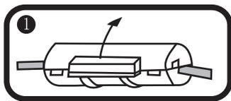
1. Если автомобиль не движется, проверьте, не перегорел ли предохранитель. Предохранитель расположен под сиденьем, рядом с аккумулятором.
