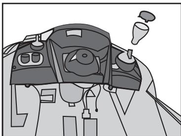
2. Установка рычага смены хода движения.
