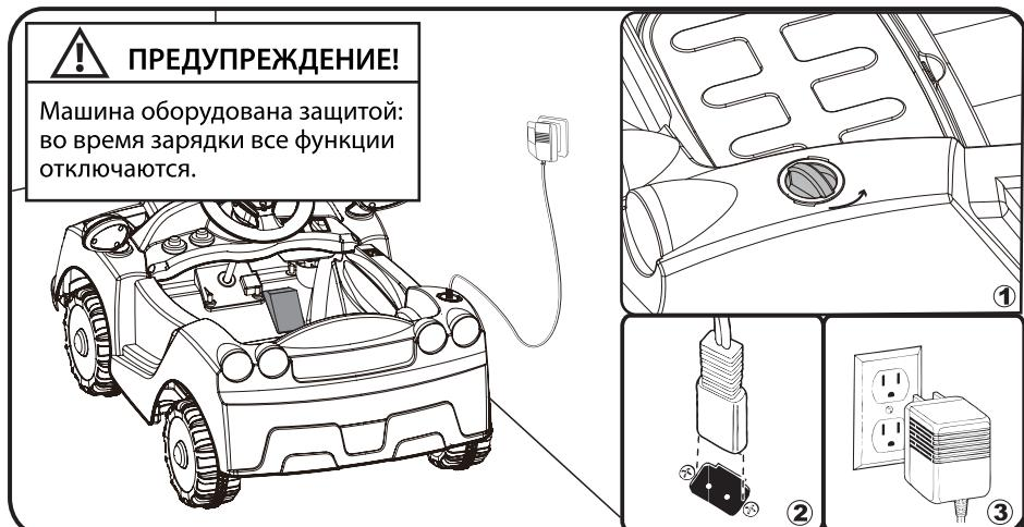
1. Поверните крышку разъема против часовой стрелки и снимите ее (крышка находится НАД ВЕДУЩИМ КОЛЕСОМ).
