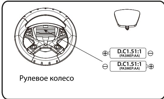
При помощи отвертки откройте крышку батарейного отсека и вставьте две батарейки размера AA (1,5В), верните крышку на место. Соблюдайте полярность!
