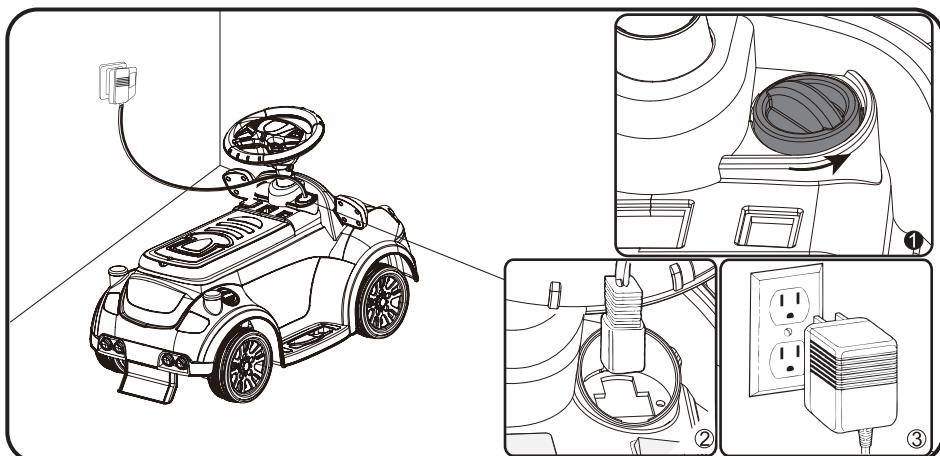
1. Поверните крышку разъема против часовой стрелки и снимите ее (крышка находится СПРАВА ОТ РУЛЯ).
