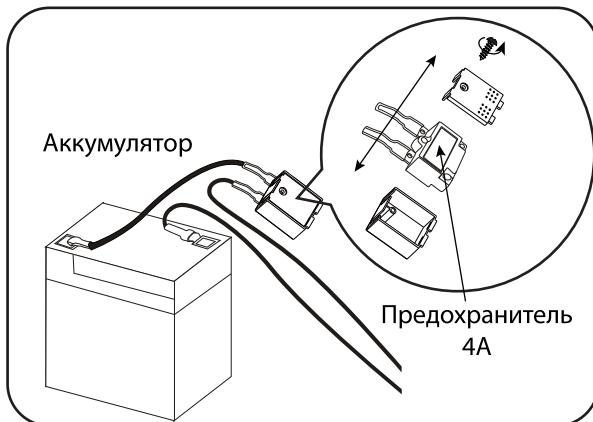
Чтобы предотвратить отключение питания предохранителем, следуйте таким инструкциям:
