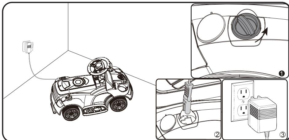
1. Поверните крышку разъема против часовой стрелки и снимите ее (крышка находится НАД ПРАВЫМ ЗАДНИМ КОЛЕСОМ).
