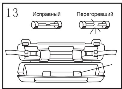
В случае если перегорел предохранитель, его необходимо заменить. Откройте коробку предохранителя, расположенную под сиденьем, и выньте перегоревший предохранитель. (Рис.13) Установите новый предохранитель и закройте крышку коробки. См. рис.13
