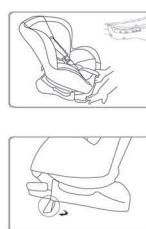
Установите регулировку кресла в третье положение. Отрегулируйте угол наклона. Установите кресло на сиденье автомобиля.
