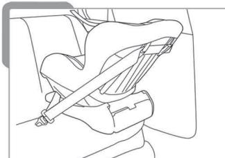
Пропустите ремень безопасности через регулирующийся держатель кресла. Вставьте пряжку в крепление на сиденье автомобиля до характерного щелчка.
