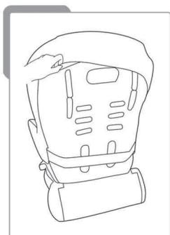
Отсоедините чехол от металлических крючков на обеих боковых сторонах спинки, а так же от двух крючков, расположенных на сидении, затем снимите чехол.
