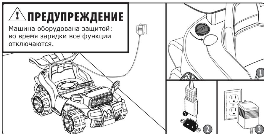
1. Поверните крышку разъёма против часовой стрелки и снимите её (крышка находится **НАД ВЕДУЩИМ КОЛЕСОМ**).
