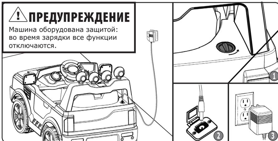
1. Поверните крышку разъёма против часовой стрелки и снимите её (крышка находится **ПОД СПОЙЛЕРОМ**).
