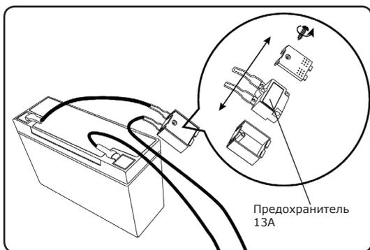
**Чтобы предотвратить отключение питания предохранителем, следуйте следующим инструкциям:**
