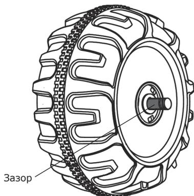
После монтажа каждого колеса на оси проверьте зазор между резьбой и колесом (смотрите на рисунке). Если зазор слишком большой, наденьте с внутренней стороны колеса две-три шайбы. После затягивания контргайки проверните колесо рукой, чтобы проверить, проворачивается ли оно свободно. Это очень важно. Если колесо проворачивается свободно, сборка проведена правильно.
