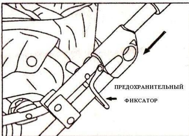
5. Разложив коляску, опустите регуляторы по обеим сторонам ручки коляски и защелкните предохранительные фиксаторы.
