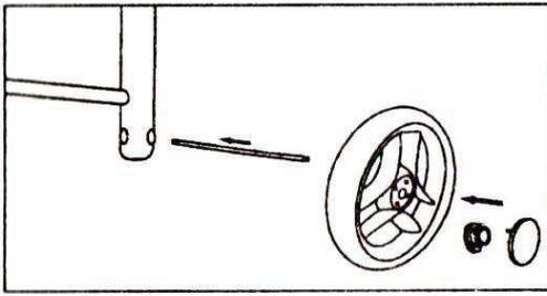
1. Вставьте ось в отверстия ножек коляски, наденьте по краям оси колесо, фиксатор колеса и колпак колеса, как показано на рисунке.
