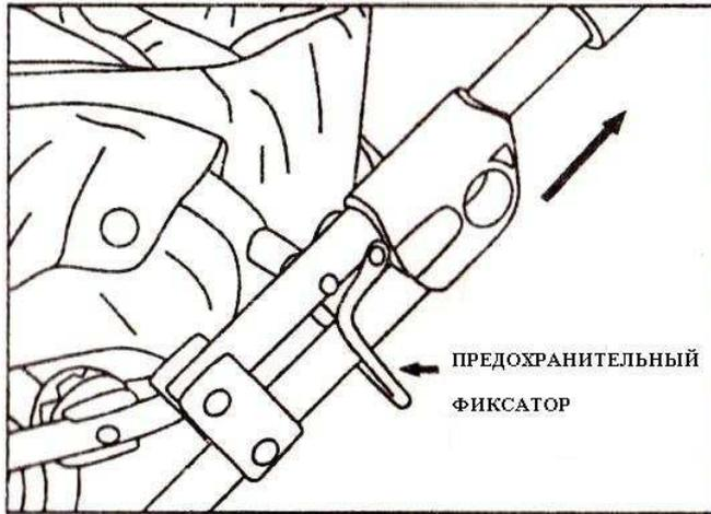
7. Чтобы сложить коляску, потяните за регуляторы по обеим сторонам ручки коляски вверх, разблокировав предохранительные фиксаторы.
