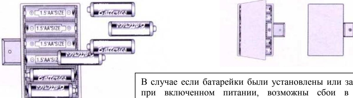
В случае если батарейки были установлены или заменены при включенном питании, возможны сбои в работе системы. Следует отключить питание, чтобы восстановить функциональность изделия.
