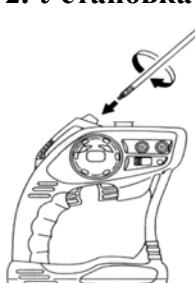
Вставьте антенну в основание в верхней части пульта управления и закрутите ее по часовой стрелке.
