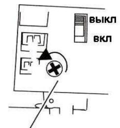
Подкрутите потенциометр на плате вертолета против часовой стрелки.
