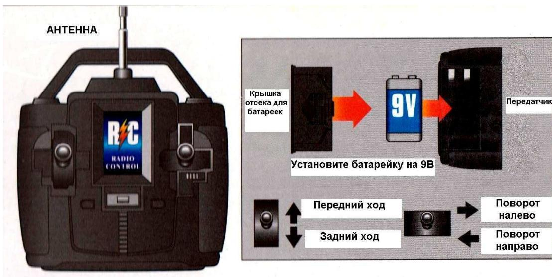
УСТАНОВИТЕ 1 БАТАРЕЙКУ НА 9В В ОТСЕК ДЛЯ БАТАРЕЕК НА ПЕРЕДАТЧИКЕ. СОБЛЮДАЙТЕ ПОЛЯРНОСТЬ!
