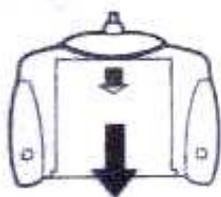
2. Установите 4 батарейки (тип АА), соблюдая полярность. Закройте крышку отсека для батареек.
