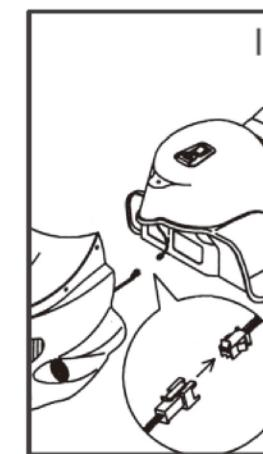
Соедините провода от передней части и базы электромобиля.
