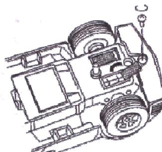
**8. Отогните щеточный контакт к задней части автомобиля.**
