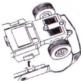
**3. Используя отвертку, разогните зажимы скобы, удерживающей контакт, и извлеките износившуюся щетку.**
