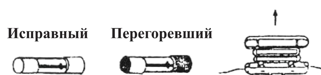
Примечание: Сила тока предохранителя -10 А.
