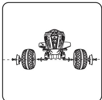
1. Установите передние колеса на корпус квадроцикла, закрепив их при помощи винтов, как показано на рисунке.
