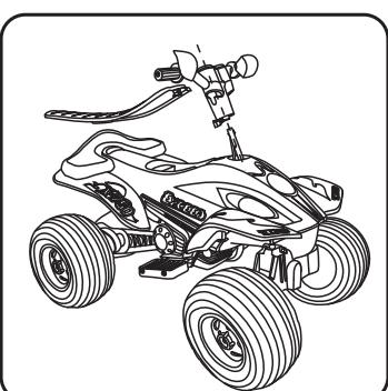
3. Установите руль на корпусе квадроцикла, зафиксируйте при помощи винта и гайки. Затем закрепите сидение на корпусе нажатием сверху вниз до щелчка (см. рисунок).
