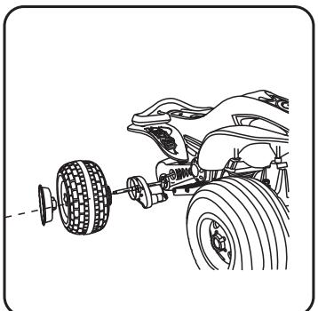
2. Установите задние колеса на корпус квадроцикла, закрепив их при помощи винтов, как показано на рисунке.
