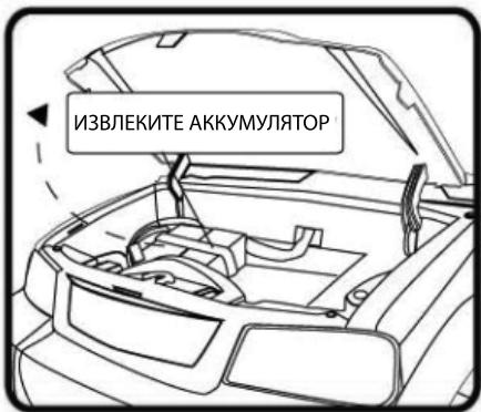
1. А. Автомобиль поставляется с заряженным аккумулятором. Однако перед началом эксплуатации необходимо зарядить аккумулятор в течение 4 - 8 часов.
