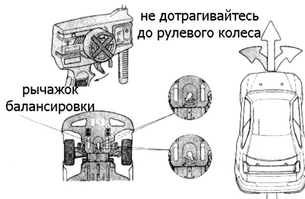
Если автомобиль не может двигаться по прямой, произведите балансировку колес при помощи рычажка на днище машины. Если автомобиль заносит вправо, переведите рычажок в положение «L», если влево – в положение «R».
