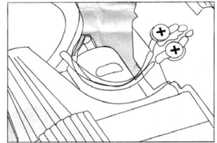
Увеличить скорость можно также за счет замены мотора модели 380 на более мощную модель 385. Обратите внимание, что желтый и красный провода на днище автомобиля являются соединительными проводами эл. платы и мотора соответственно.
