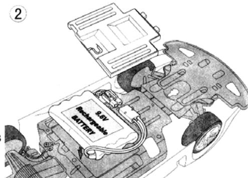
Закройте крышку отсека, зафиксируйте защелкой
