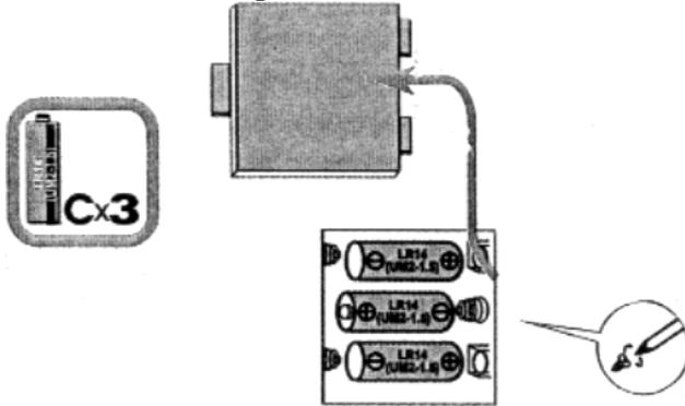
Используя отвертку, раскрутите шуруп в крышке отделения для батареек. Вставьте 3 батарейки размера «С», соблюдая полярность. Закройте крышку, закрутите шуруп.
