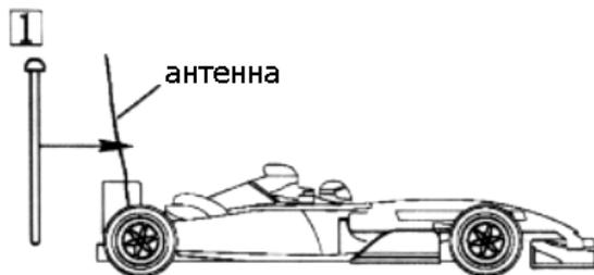
1 Проденьте антенну через направляющую скобу, закрепите ее на корпусе автомобиля. Освободите скобу, наденьте ограничитель.
