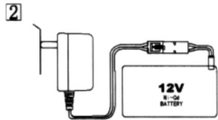
2 Вставьте штекер зарядного устройства в патрон аккумулятора, подключите зарядное устройство к эл. розетке и зарядите аккумулятор в течение 12 часов.
