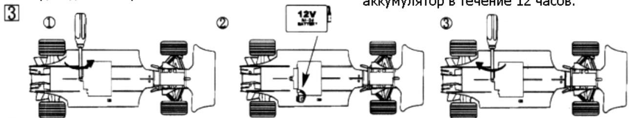
3 При помощи отвертки выкрутите шуруп из крышки на днище автомобиля.
