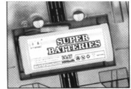
Установите заряженный аккумулятор в отсек на днище автомобиля в соответствии со схемой
