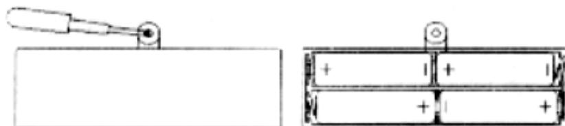
Используя отвертку, раскрутите шуруп и откройте крышку отделения для батареек. Вставьте 4 батарейки размера «AA», соблюдая полярность, закройте крышку и закрутите шуруп. Перед началом игры установите выключатель питания в положение «ON». По окончании игры не забудьте перевести выключатель в положение «OFF».
