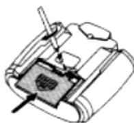
закройте крышку, закрутите шуруп
