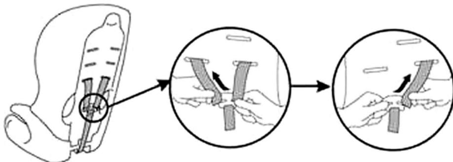
Отцепите эластичный ремешок в нижней части чехла спинки, чтобы получить доступ к ремням безопасности. Отсоедините плечевые ремни от крючков соединительной пластинки, находящейся сзади спинки. Вытяните ремни через отверстия спереди спинки.
