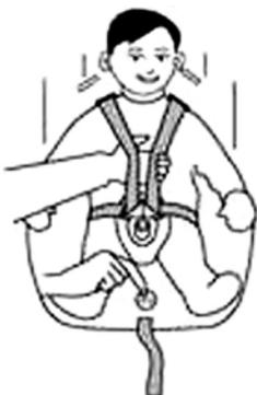
Для того чтобы ослабить натяжение ремней безопасности автокресла, нажмите на рычажок регулировки, расположенный под чехлом сиденья в передней его части. Одной рукой нажмите на лапку с надписью «Press», а другой рукой возьмитесь за плечевые ремни. Потяните плечевые ремни на себя, чтобы ослабить их натяжение. После того как вы отпустите рычажок регулировки, убедитесь, что он не зажегнул регулировочный ремень.
