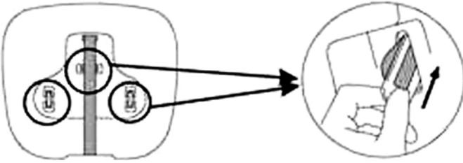
Переверните оба боковых фиксатора ремней и направьте их узким концом в отверстия в основании сиденья автокресла, а затем в отверстия в чехле сиденья.
