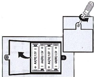
1. Используя отвертку, выкрутите болт из крышки отделения для батареек в нижней части инструмента, откройте крышку.
