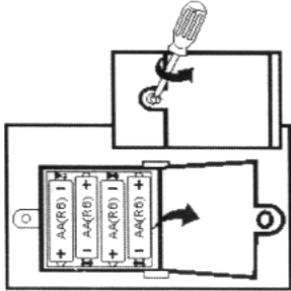
1. Используя отвертку, выкрутите болт из крышки отделения для батареек в нижней части инструмента, откройте крышку.
