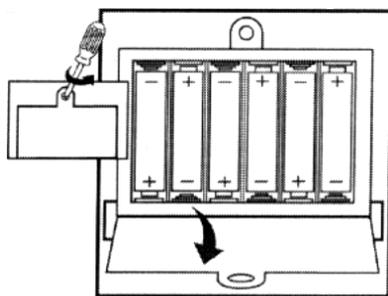
1. Используя отвертку, выкрутите болт из крышки отделения для батареек в нижней части инструмента, откройте крышку.
