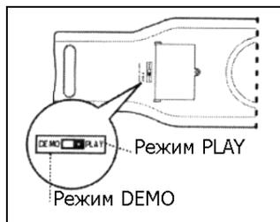
Перед началом игры переведите переключатель в положение «PLAY». Режим «DEMO» предназначен только для предпродажной демонстрации инструмента. В режиме «DEMO» инструмент автоматически отключается через 30 секунд. В режиме «PLAY» инструмент автоматически отключается через 3 минуты простоя.
