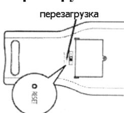
Если в работе инструмента возникли какие-то сбои, вы можете перезагрузить его, нажав кнопку «RESET» в нижней части инструмента при помощи тонкого стержня.
