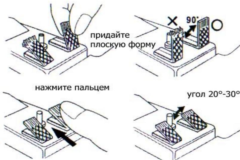
\*Если щеточные контакты не выпрямлены или установлены неправильно, это повлияет на прохождение электрического тока, что может помешать плавному ходу поезда.
