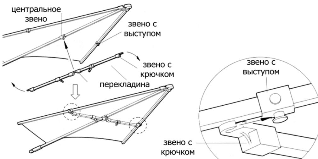
(2) Установите крыло на корпус дельтаплана, продев стержни с крючками на концах в соответствующие пазы на опоре крыла и на поперечной перекладине, защелкните кончик средней части рамы крыла в прорезь на задней части корпуса.
