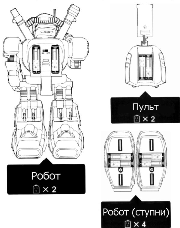
Откройте крышки батарейных отсеков на ступнях и спине робота и в задней части пульта управления. Установите батарейки в соответствии с рисунками, соблюдая полярность. Закройте крышки батарейных отсеков.
