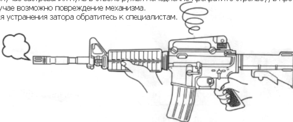
Использование загрязненных, неровных пуль, а также пуль диаметром свыше 6 мм может спровоцировать забивание пуль в стволе ружья.
