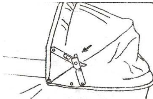
6. Нажмите на фиксатор для установки крышки коляски в положение «защита»
