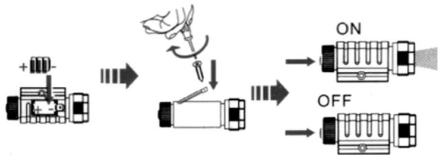
Установите фонарик на направляющую планку пистолета, зафиксируйте его с помощью шурупов.
