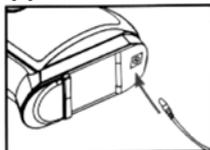
Вставьте штекер зарядного устройства в гнездо зарядки и подключите зарядное устройство к сети 220V
