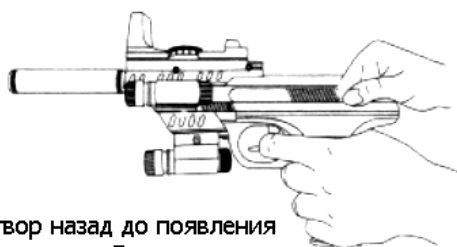
1. Нажмите на защелку и снимите магазин
