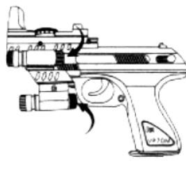
8. Фонарик и прицел включаются при помощи ручек, указанных стрелками
