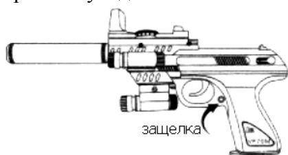
1. Нажмите на защелку и снимите магазин
