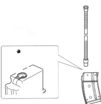
3. Протолкните пули внутрь магазина при помощи прилагающегося стержня.
