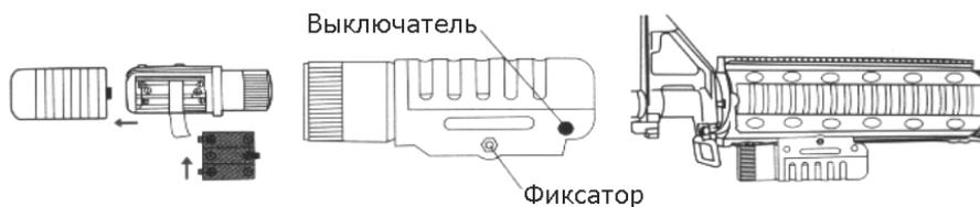
В качестве источника питания в фонаре используются 3 пальчиковые батарейки. Вставьте фонарь в нижнюю направляющую ствола, закрепите с помощью фиксатора. Для того чтобы включить фонарь, нажмите на кнопку выключателя.
