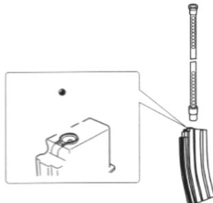
3. Протолкните пули внутрь магазина при помощи прилагающегося стержня. Не прилагайте излишних усилий, чтобы не повредить магазин.
