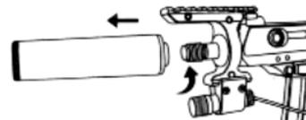
Установите ручку затвора, закрутив ее по часовой стрелке в соответствующее отверстие ружья
