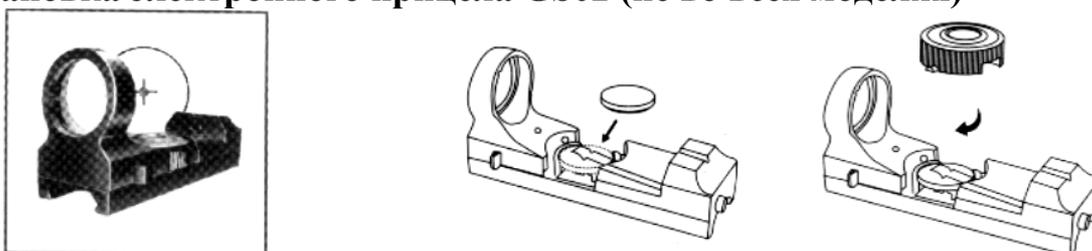
Откройте крышку батарейного отсека прицела и вставьте 1 батарейку 3V (CR2025 или эквивалент), закрутите крышку по часовой стрелке. Если заряд батарейки станет низким, установите новую батарейку. «Севшую» батарейку следует немедленно извлечь из прицела.
