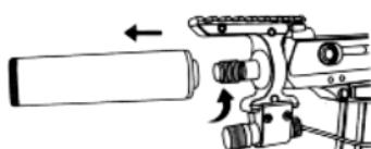
Установите ручку затвора, закрутив ее по часовой стрелке в соответствующее отверстие ружья
