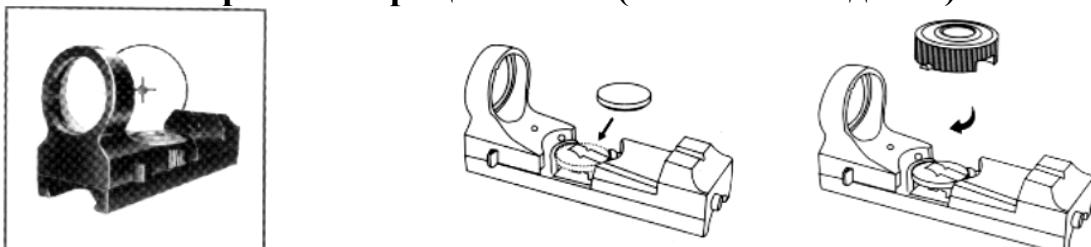
Откройте крышку батарейного отсека прицела и вставьте 1 батарейку 3V (CR2025 или эквивалент), закрутите крышку по часовой стрелке. Если заряд батарейки станет низким, установите новую батарейку. «Севшую» батарейку следует немедленно извлечь из прицела.
