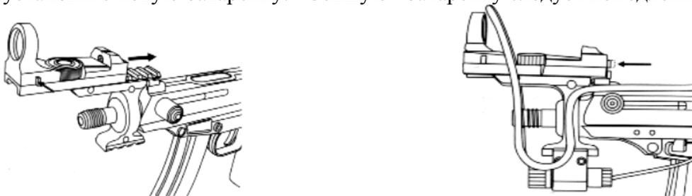
Задвиньте прицел в верхнюю направляющую планку ружья, нажмите на рычажок и установите прицел в нужное положение. Для включения / выключения прицела нажмите кнопку выключателя ON/OFF.
