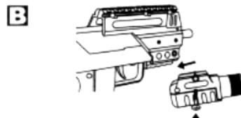
Установите фонарик на ружье, зафиксируйте шурупом
