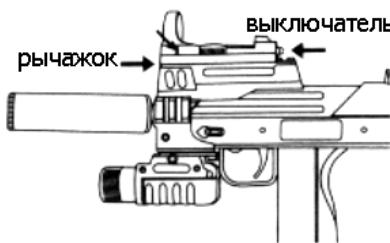
Задвиньте прицел в верхнюю направляющую планку ружья, нажмите на рычажок и установите прицел в нужное положение. Для включения / выключения прицела нажмите кнопку выключателя ON/OFF.
