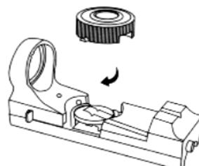
Откройте крышку батарейного отсека прицела и вставьте 1 батарейку 3V (CR2025 или эквивалент), закрутите крышку по часовой стрелке. Если заряд батарейки станет низким, установите новую батарейку. «Севшую» батарейку следует немедленно извлечь из прицела.
