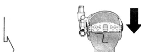
Наденьте обруч на голову (приемник должен оказаться справа). Если размеры обруча не соответствуют размерам головы, отрегулируйте длину ремней.
