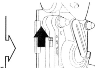
Установите выключатель в задней части приемника в положение VS MODE
